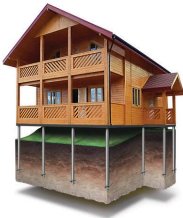
Los Pilotes Helicoidales son pilotes de acero con hélices de distintos diámetros soldadas. El pilote es introducido, por rotación, mediante motores hidráulicos en el terreno hasta obtener la profundidad de cálculo y verificar la capacidad real del pilote mediante la relación entre el par de apriete obtenido y la capacidad de carga / tensión del pilote.
